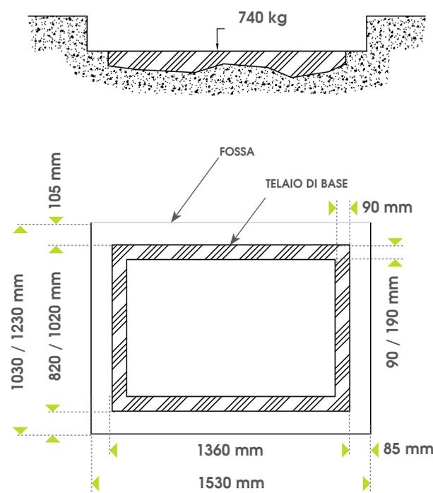
L'altezza minima dell'ultima alzata non deve essere inferiore a 100mm per non interferire con i movimenti di traslazione del pianale:
