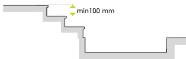
\* Con bordo fisso contenimento pavimentazione: +15 mm
